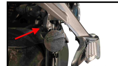
Posizionare la staffa in dotazione sulla pedana come mostrato. Serrare solo dopo aver riposizionato la vaschetta. Position the supplied bracket on the footrest as shown. Tighten only after replacing the tray.
