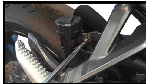
Rimuovere la vaschetta dell'olio dei freni ed il suo supporto. Andrà riposizionata successivamente sul telaio. Remove the brake fluid pan and its support. It will be repositioned on the chassis later.
